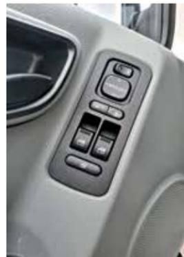
Блок регулировки внешних зеркал заднего вида, подъема/опускания стекол, блокировки дверей
