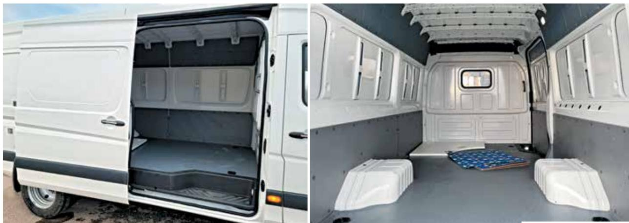
Объем грузового отсека этой самой длинной версии фургона со средней высотой крыши – 10,4 м³. Довольно широкие из-за двухкатной ошиновки колесные арки не позволяют разместить сзади палету поперек. Такелажные петли предусмотрены, увы, только на полу
