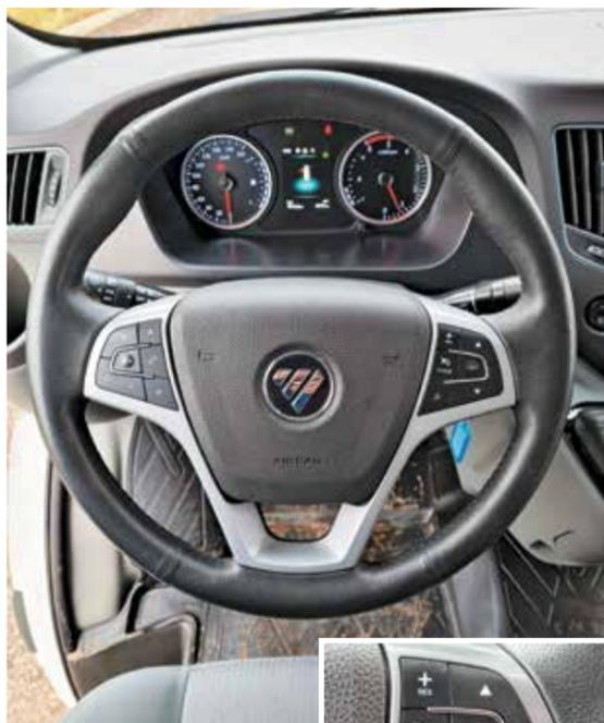
◆ Многофункциональное рулевое колесо, на которое выведено, в частности, управление круиз-контролем
