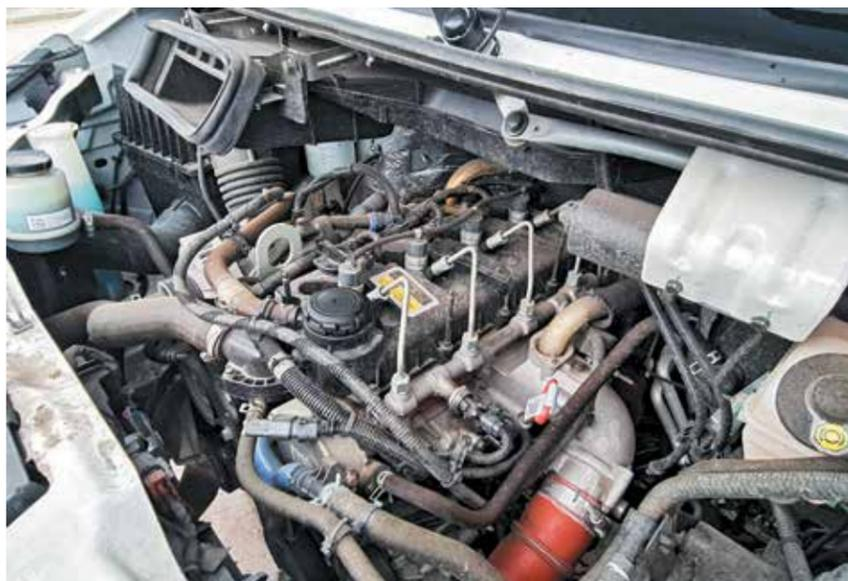
◆ В моторном отсеке хорошо знакомая нашим перевозчикам рядная «четверка» Cummins ISF 2.8 с системой впрыска топлива common rail
