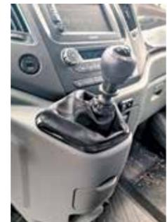
Рычаг 6-ступенчатой МКП на приливе центральной консоли. Есть «защита от дурака» – для включения передачи заднего хода надо приподнять кольцо под набалдашником
