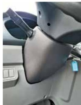
Рулевая колонка не регулируется ни по высоте, ни по углу наклона. Обновленный Тоано уже получит эту опцию
