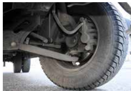
Независимая передняя подвеска с пружинно-амортизаторной стойкой собрана на мощном подрамнике
