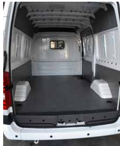
Это стандартный фургон с односкатными колесами. Между колесными нишами здесь уместится стандартная палета
