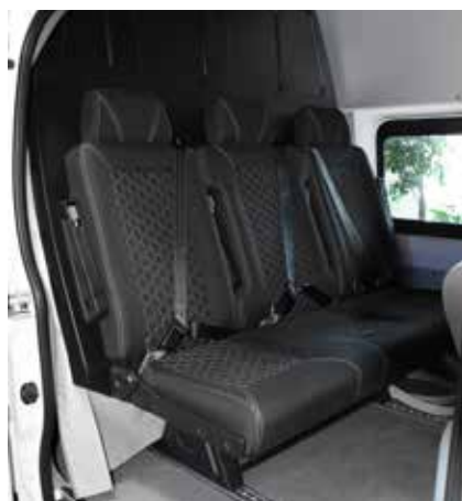
Улучшенный вариант «на троих». Причем задний ряд кресел перемещается по направляющим вместе с перегородкой
