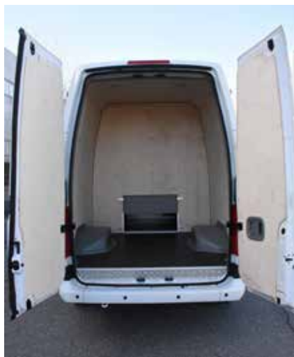
Грузовой отсек «комби» обшит фанерой. На полу тоже фанера, но влагостойкая и рифленая, чтобы не скользить
