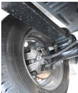
В задней подвеске «трудятся» двухлистовые рессоры. Хорошо виден задний дисковый тормозной механизм
