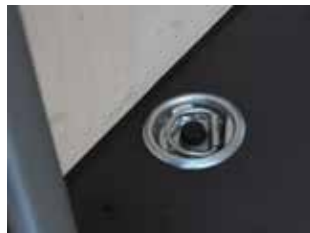
Крепежных петель четыре или шесть – в зависимости от длины грузового отсека
