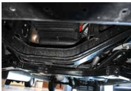
Поддон двигателя снизу надежно прикрыт могучей поперечной балкой. Возможна установка дополнительной защиты
