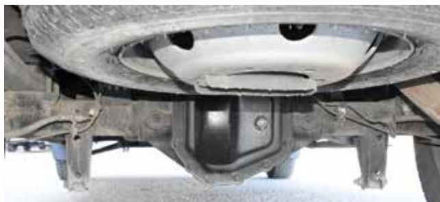
Задний мост Dana производит в Поднебесной. Запасное колесо располагается под полом в заднем свесе
