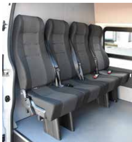
Это самое простое, базовое исполнение «комби» – четырехместный задний диван закреплен неподвижно
