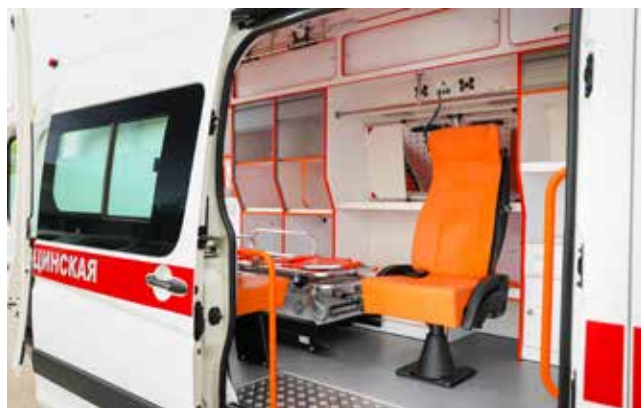
Обычную скорую помощь, как и реанимационный автомобиль, делают на базе высоких версий машины. Даже самый рослый доктор сможет стоять здесь в полный рост
