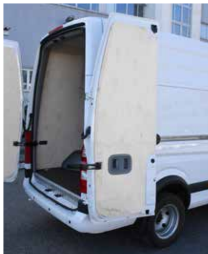
Опционные двери распахиваются на 270 градусов и фиксируются к борту кузова специальными креплениями
