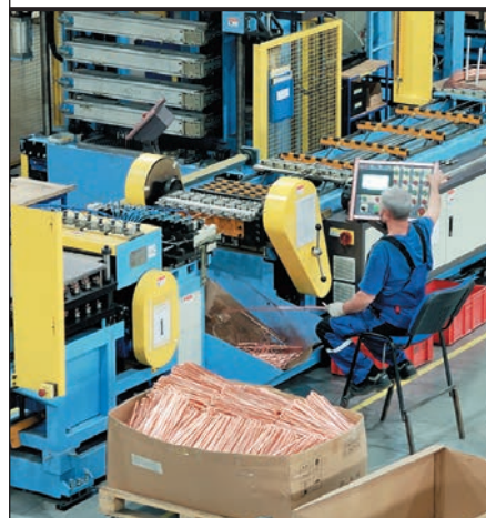
В цехе № 2 размещено производство трубчато-пластинчатых теплообменников
