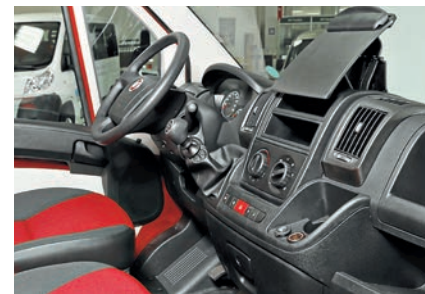
Рычаг переключения передач расположен на консоли панели приборов и не мешает водителю при необходимости выходить через правую дверь
