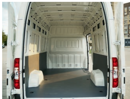
Под полом нет кардана, арки узкие – именно за это выбирают передний привод
