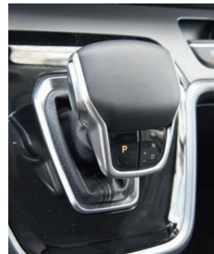
Селектор редкой на коммерческих автомобилях восьмиступенчатой автоматической коробки передач
