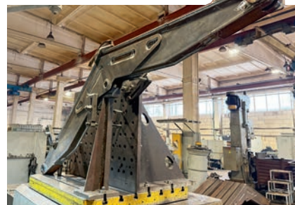
Все шарниры высокоточные, проходят обработку на собственных расточных станках
