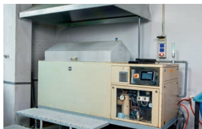
Камера соляного тумана для проверки коррозионной стойкости инструмента
