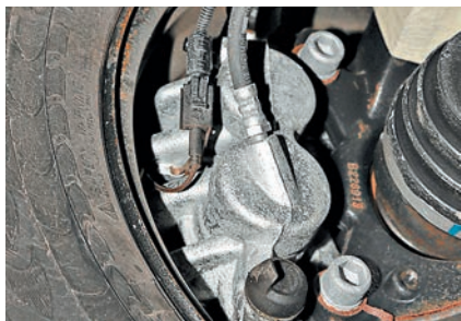
Суппорты передних тормозов – двухцилиндровые с плавающей скобой
