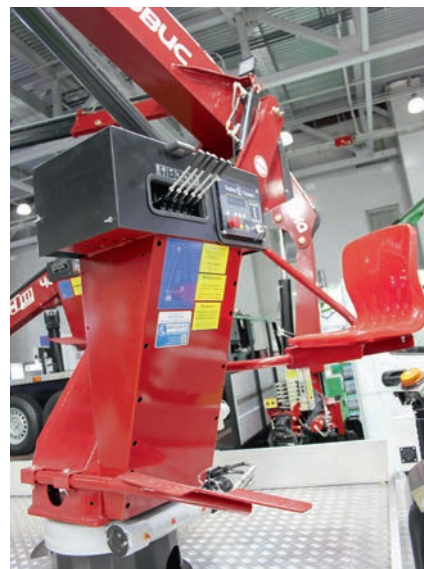
Пульт управления с сиденьем оператора расположен на поворотной колонне
