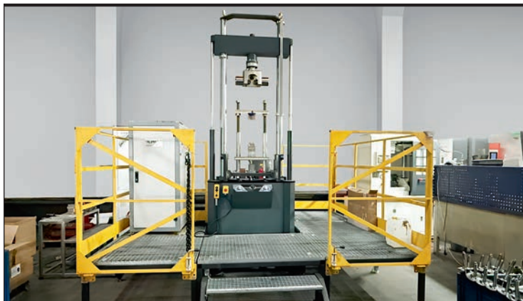
Новый испытательный стенд позволяет исключить необходимость прокатки амортизаторов перед установкой на автомобиль
