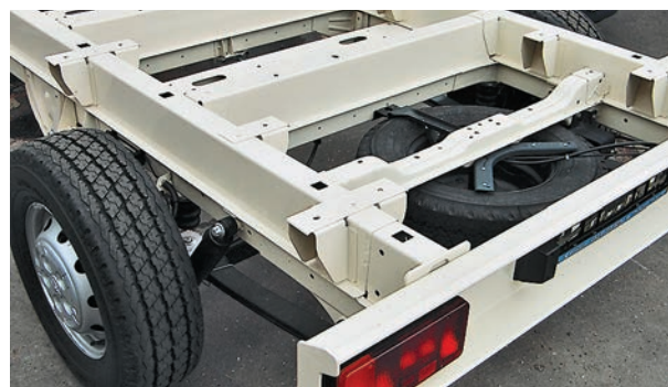
В отличие от цельнометаллических фургонов с несущим кузовом шасси под надстройки делают на раме
