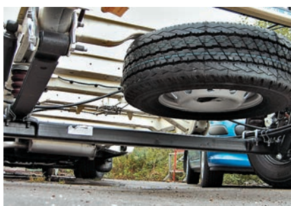
Балка задней подвески из трубы квадратного сечения – подавая задним ходом, ее можно погнуть о пенек
