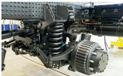
Со снятым колесом конструкция независимой подвески видна как на ладони
