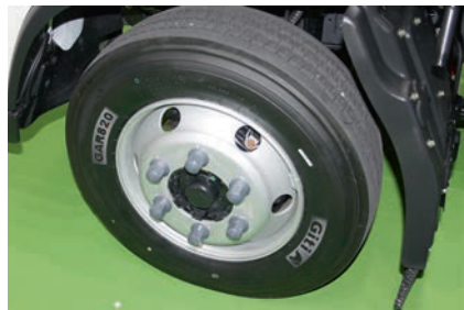
17,5-дюймовые колеса крепятся к ступицам по стандарту ISO – с центровкой по пояску. Гайки крепления – с фланцевыми шайбами и правой резьбой
