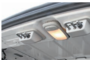
За освещение грузового отсека отвечают два штатных, довольно тусклых плафона
