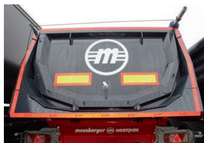
Откидная задняя стенка оборудована автоматическим запорным устройством
