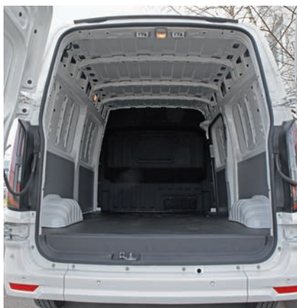
Объем кузова фургона со средней крышей – почти 8 кубических метров, внутренняя высота – 1470 мм
