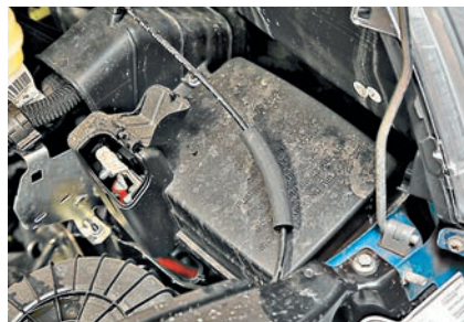
Если дренаж коробки воздухопритока зарос семенами растений, дождевая вода льется через край и вызывает замыкания в блоке предохранителей
