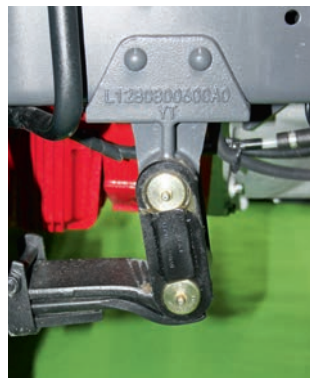
В шарнирах рессор – металлические втулки с пресс-масленками
