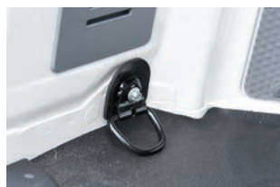
Петель для крепления груза в грузовом отсеке нового фургона четыре пары
