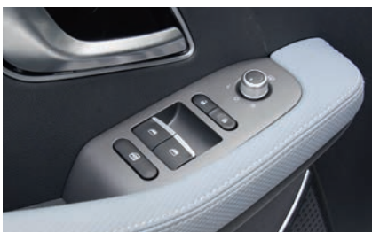
На подлокотнике водительской двери стандартный набор клавиш – управление стеклоподъемниками, зеркалами и замком
