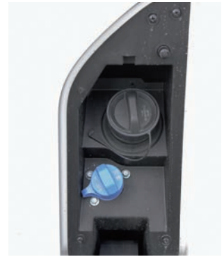
Под лючком крышки расположены две заливные горловины: для дизельного топлива и раствора мочевины
