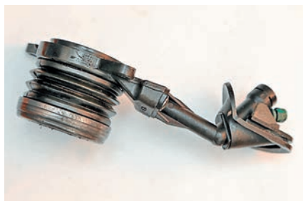
Рабочий цилиндр сцепления – внутри. Надо снимать коробку передач
