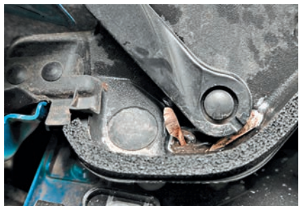
Если дренаж коробки воздухопритока зарос семенами растений, дождевая вода льется через край и вызывает замыкания в блоке предохранителей
