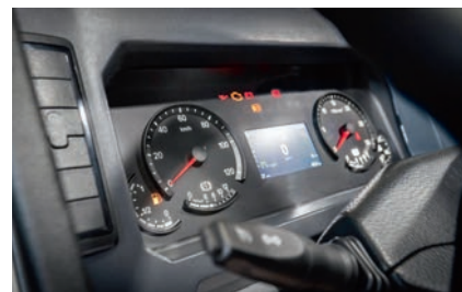
Основные приборы – аналоговые. В центре – дисплей бортового компьютера
