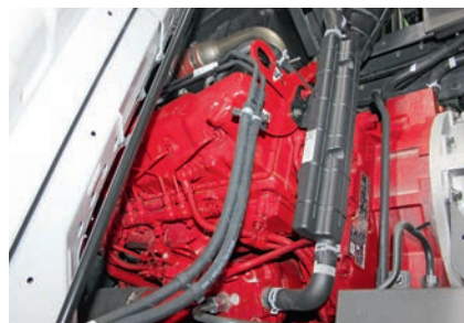
Двигатель – оригинальный 3,8-литровый Cummins китайского производства
