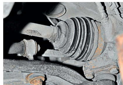
Пока резиновый чехол ШРУСа герметичен, шарнир будет в порядке
