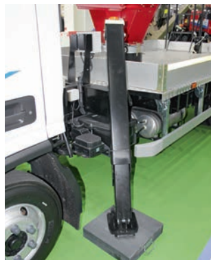
Передние аутригеры расположены под углом к продольной оси машины...
