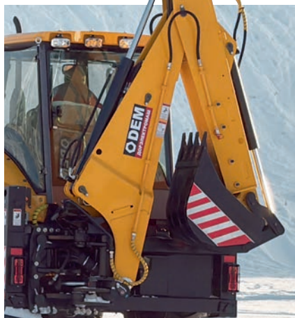
Каретка может смещаться на 1190 мм, заметно увеличивая рабочую зону
