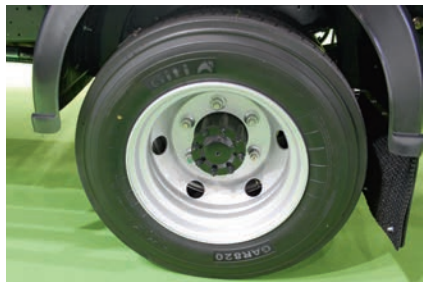
17,5-дюймовые колеса крепятся к ступицам по стандарту ISO – с центровкой по пояску. Гайки крепления – с фланцевыми шайбами и правой резьбой
