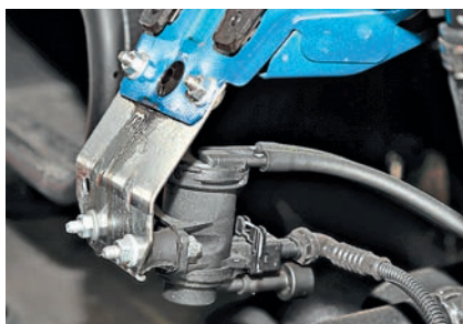
...и если канал не рассверлить, может выйти из строя сам клапан
