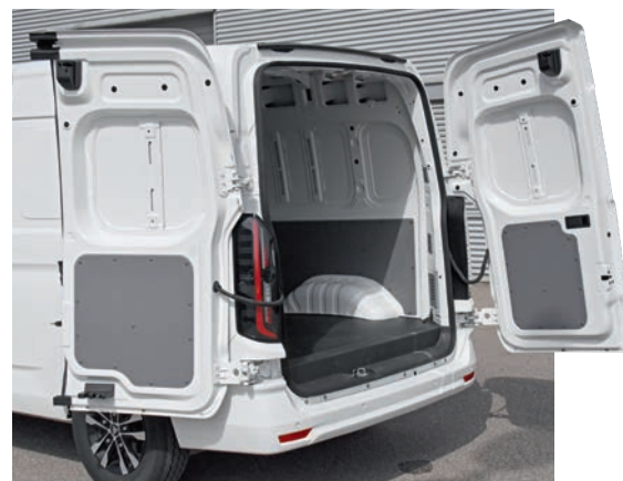
Минимальный и максимальный углы открытия задних дверей. Максимальный угол (247°) – опция за дополнительную плату
