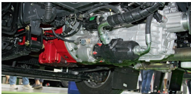
Отбор мощности для гидросистемы подъемника – на коробке передач шасси. Гидронасос закреплен на КОМ и легкодоступен снизу
