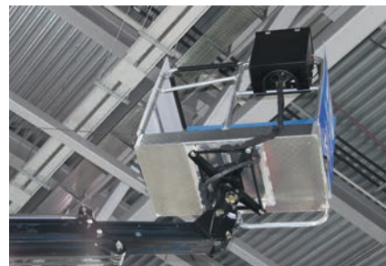
Корзина – алюминиевая с рычажным механизмом поворота
