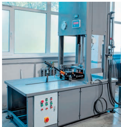
Уникальный стенд для всестороннего тестирования подкатных домкратов
