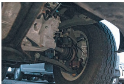
Передняя подвеска независимая, на поперечных рычагах и стойках McPherson
