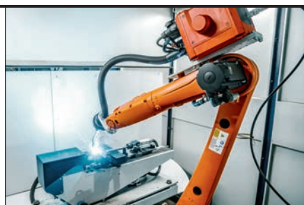
Роботизированные комплексы с числовым программным управлением для автоматической сварки по точной траектории с постоянным контролем режимов
