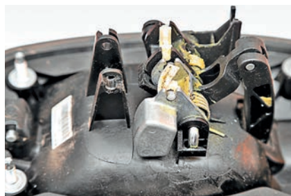
Сухари тросов замка двери держат хлипкие пластмассовые кронштейны
