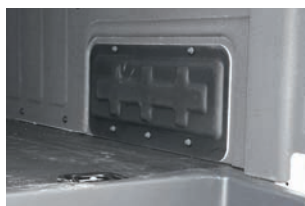
В передней стенке грузового отсека лючок для перевозки длинномерных грузов
