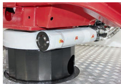
Поворотную колонну вращает гидромотор с редуктором
