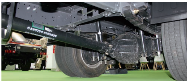
Ведущий мост типа «банджо» с гипоидным редуктором. Подвешен на четырехлистных рессорах с двухлистовым подрессорником
