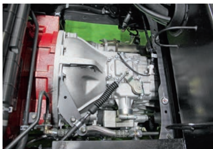
Коробка передач – марки ZF с тросовым приводом механизма переключения
