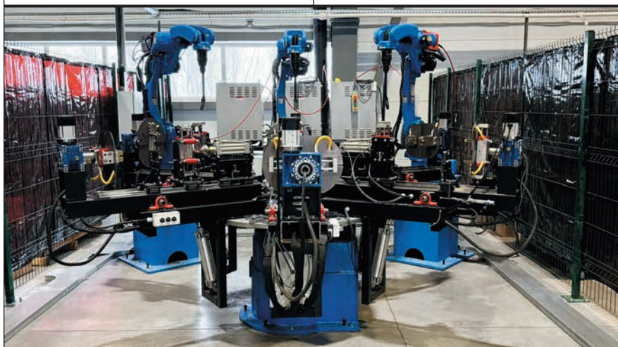
Комплексы не оставляют сварочных брызг и прижогов на резервуаре, что улучшает внешний вид и коррозионную стойкость амортизатора
