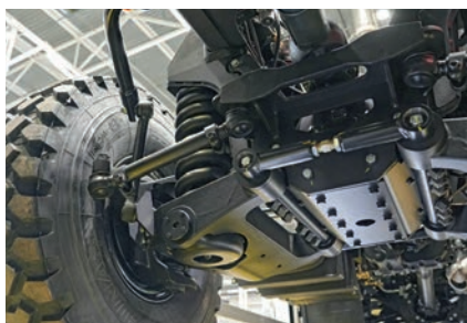
Между осями нижних рычагов независимой подвески появилась распорка-усилитель
