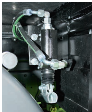
Аварийный гидронасос по конструкции напоминает ручной домкрат
