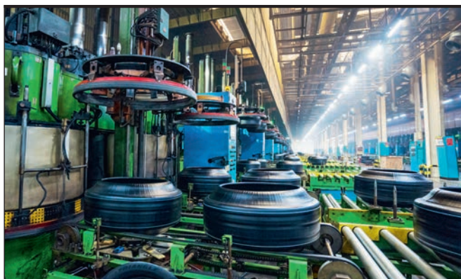
«Трайангл шина» разработала технологии вулканизации методом электромагнитного индукционного нагрева
