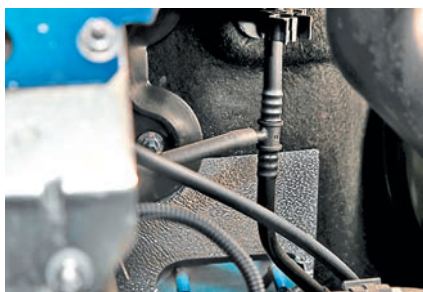
Дефект патрубка тройника вызывает неисправности системы EGR...
