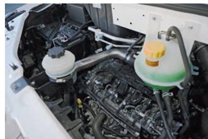
Силовой агрегат расположен поперечно, система питания – Common Rail
