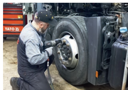
Облегченная конструкция пневмогайковертов снижает нагрузку на мастера и повышает производительность труда
