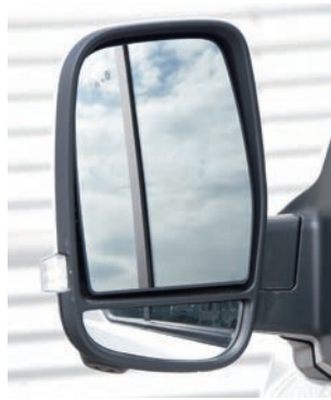
Двухсекционное зеркало обеспечивает хороший обзор назад. В нижней части – камера заднего вида системы кругового обзора
