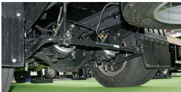
Тормоза задних колес – барабанные с пневмокамерами, энергоаккумуляторами и кулачковыми механизмами разжима колодок
