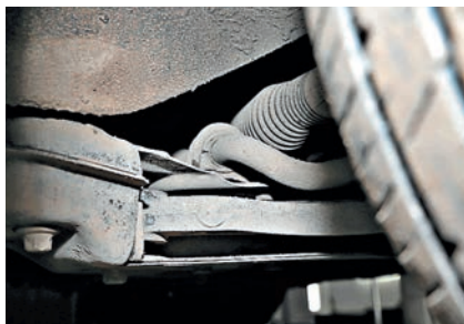
...а подушки стабилизатора изредка (через 100 тыс. км) требуют замены
