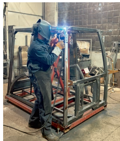
Каркас кабины соответствует жестким требованиям ROPS/FOPS
