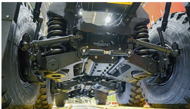
Самый интересный ракурс БАЗа – вид снизу. Сразу понятно, откуда берется 560 мм дорожного просвета
