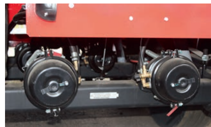
На осях BPW применены барабанные тормоза с кулачковым разжимом колодок
