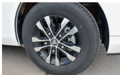
Шины с высоким, 75-м профилем сегодня можно встретить разве что на внедорожниках и легких «коммерсантах»
