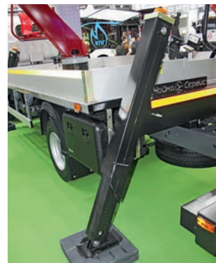
... а задние – перпендикулярно. Горизонтальных выдвижных балок нет
