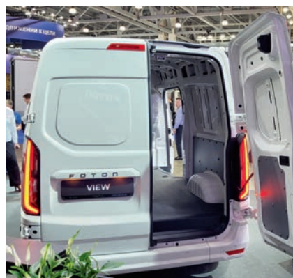
У задних распашных дверей предусмотрены три угла открывания
