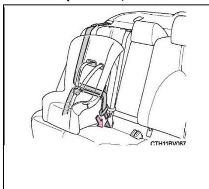
4. Если система безопасности для детей не оснащена стопором (системой фиксации ремня безопасности), закрепите систему безопасности для детей фиксирующим зажимом.
