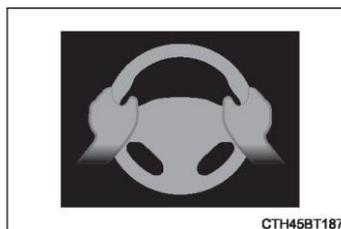
• При работе функции удержания полосы движения система определяет, что водитель едет, не держась за руль. Если водитель продолжает ехать без рук на рулевом колесе, раздается звуковой сигнал, предупреждающий водителя, и эта функция временно отключается. Это предупреждение срабатывает также, когда водитель в течение некоторого времени управляет автомобилем лишь с небольшими манипуляциями с рулевым колесом.
