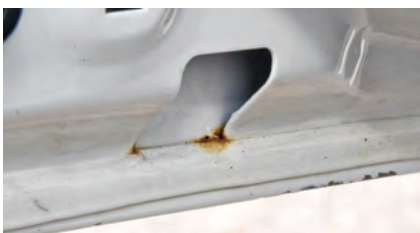
Изнутри дверей видны ржавые пятнышки
