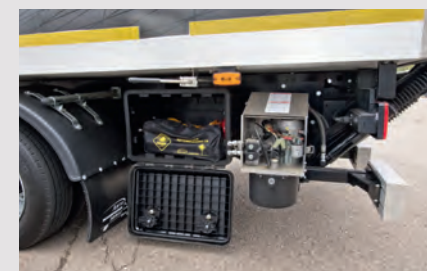
Рядом с «потрохами» гидроборта (их крышка снята) — вещевой ящик Daken
