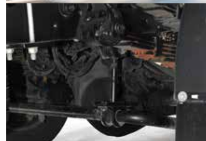
В передней и задней подвесках Forland 8 установлены стабилизаторы поперечной устойчивости
