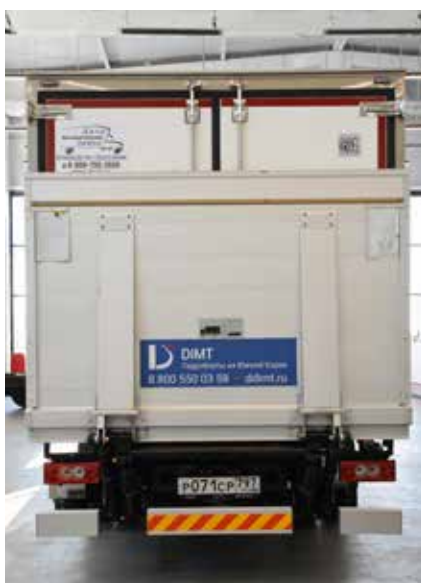
Корейский гидроборт не только облегчает погрузку, но и защищает двери фургона от абразивного износа
