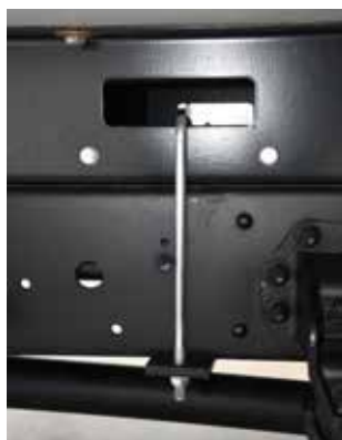
Рама выполнена из легированной высокопрочной стали. Толщина профиля 6 мм. Соединения элементов на заклепках и болтах. Подрамник фургона здесь тоже из стального профиля
