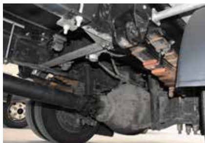
Задний мост, подвешенный на мощных рессорах с подрессорниками, от того же производителя, что и коробка передач
