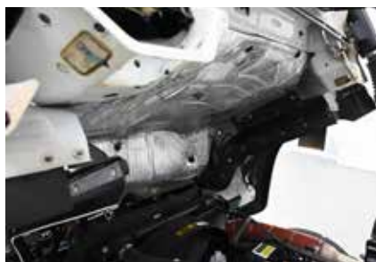
Под кабиной видно дополнительную шумо- и теплоизоляцию
