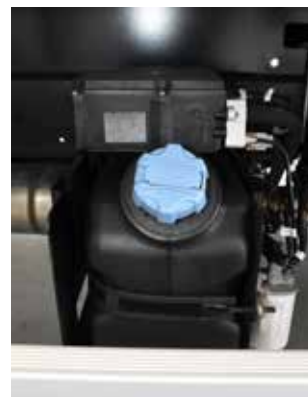
Двигатель выполняет экологические нормы Евро-5. Бак для мочевины расположен справа
