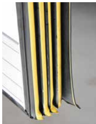
Многослойные уплотнения дверей фургона должны предотвращать утечки холода
