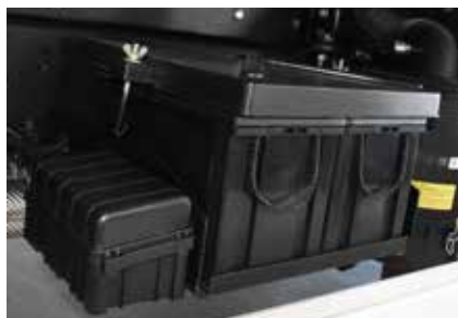
Два аккумулятора размещены в пластиковых ящиках слева за кабиной. Бортовая сеть 24-вольтовая
