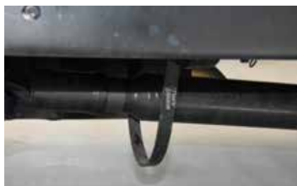
Обрыв кардана – серьезная и опасная поломка. Китайцы решили подстраховаться
