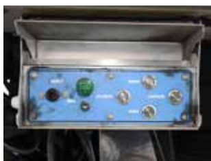
Стационарный пульт управления гидробортом расположен слева под кузовом
