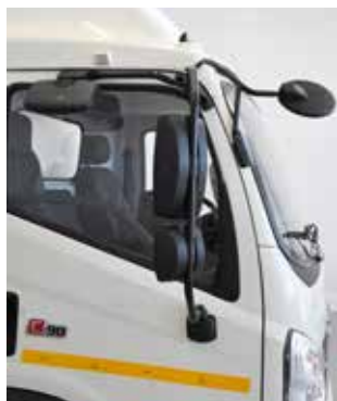
Зеркала обеспечивают прекрасный обзор назад и видимость «слепых» зон
