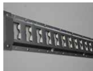
По бортам изотермического кузова расположили планки для крепления груза
