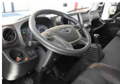
Рулевая колонка имеет хороший диапазон регулировок по наклону и вылету
