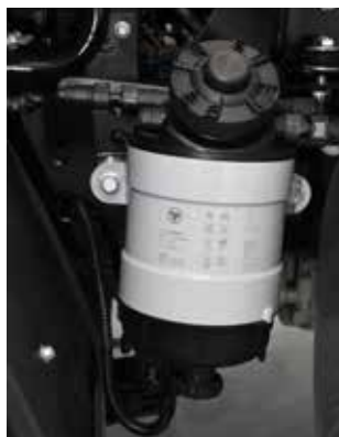
Для облегчения холодного пуска дизеля топливный фильтр обогревается
