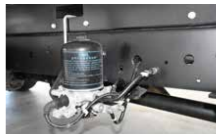
Пневмоаппаратура тормозной системы от китайской компании SORL
