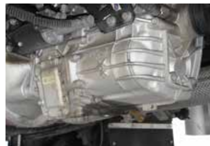
Шестиступенчатая коробка передач WLY6G55 допускает установку коробки отбора мощности
