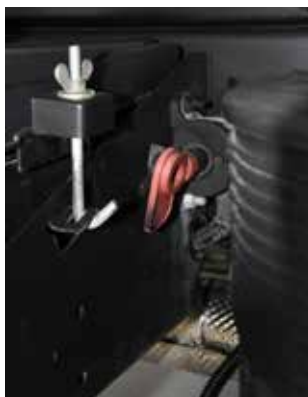
Установлен выключатель массы, который позволяет полностью обесточить автомобиль
