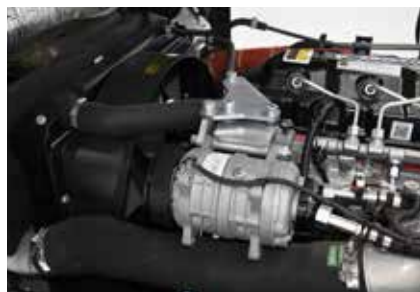
Компрессор обеспечивает работу холодильной установки. Для работы компрессора требуется замена приводного ремня
