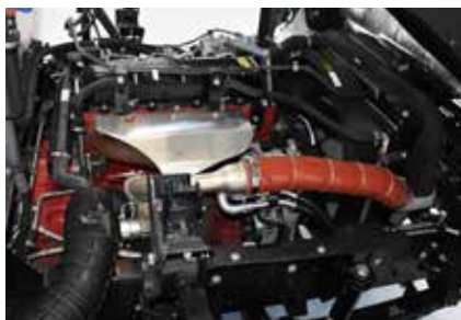
Под капотом (точнее, под кабиной) 3,8-литровый турбодизель ISF3.8s5154 китайского производства мощностью 152 л. с.
