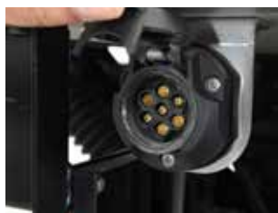
Через эту розетку можно подключить выносной проводной пульт для работы с бортом
