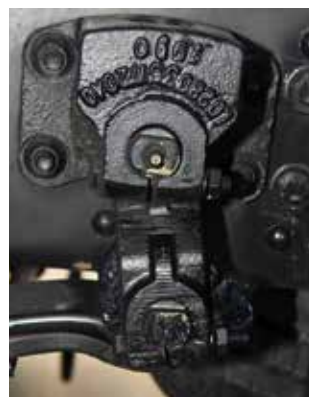
Ходовая часть Forland 8 заставляет вспомнить, что такое смазочный шприц
