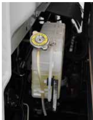
Расширительный бачок системы охлаждения вынесен за кабину
