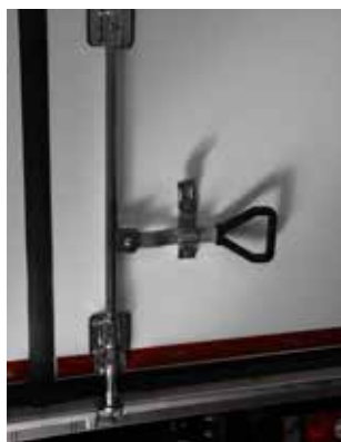
Петли и запорная арматура дверей фургона выполнены из нержавеющей стали
