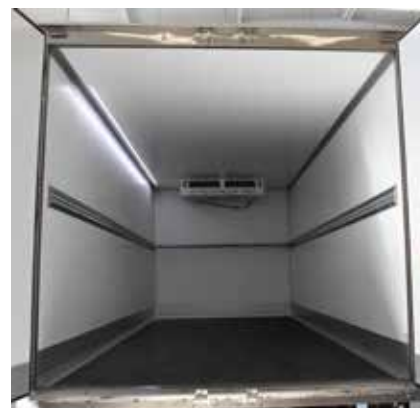
Усиленный пол фургона имеет несколько слоев покрытия. Освещение обеспечивает светодиодная лента
