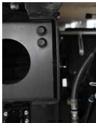
Рама выполнена из легированной высокопрочной стали. Толщина профиля 6 мм. Соединения элементов на заклепках и болтах. Подрамник фургона здесь тоже из стального профиля
