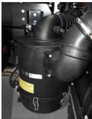
«Бочка» воздушного фильтра расположена за левым передним колесом
