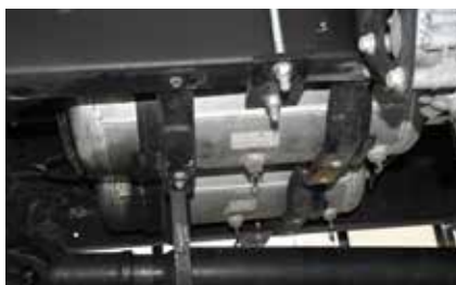
Воздушные ресиверы спрятаны между лонжеронами рамы
