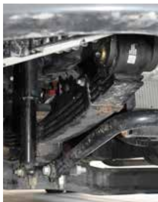
Впереди четыре полноценных листа рессор во всю длину плюс амортизаторы
