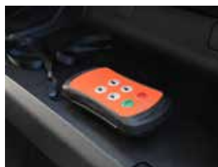
Доступен и третий вариант управления гидробортом – беспроводной пульт
