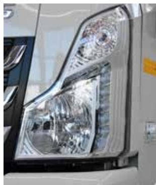
Основной головной свет га-логенный, дневные ходовые огни светодиодные
